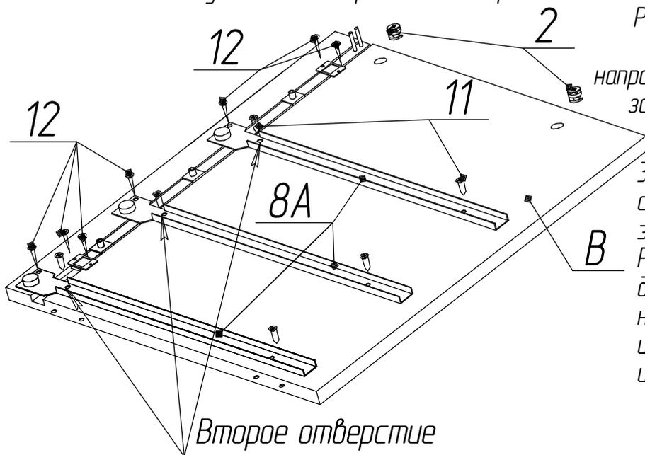
Разложить по намеченным отверстиям диаметром 5x11 левые составляющие направляющих роликовых поз. 8AL (3 шт) и зафиксировать шурупами 6,3x11,5 поз. 11 (6шт) и шурупами 3x13 поз.13(3шт).
