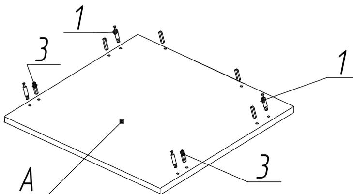
5. В стенку горизонтальную тумбы Б с наружной стороны прикрутить ролики поз 9 шурупами поз. 12 (16 шт). В отверстия с внутренней стороны диаметром 5x11 мм вкрутить винты эксцентриковые поз. 1(4 шт). поз.1, в отверстия диаметром 8x14 мм. вставить шканты поз.3(6 шт).
