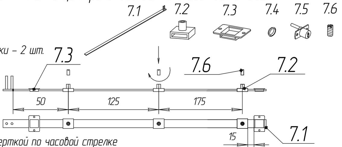
Винты 7.6 зажать отверткой по часовой стрелке
