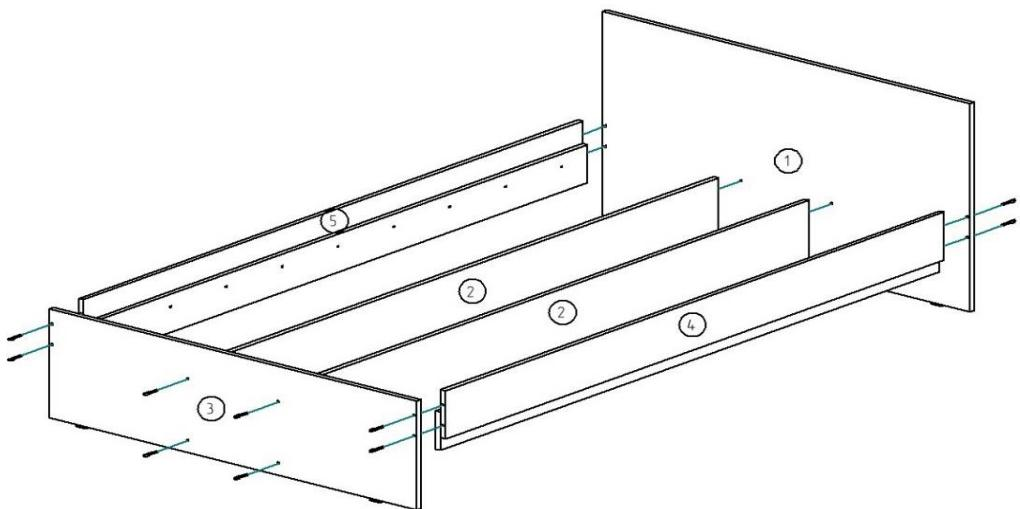
4. Соедините детали 2, 4, 5 и детали 1, 3 с помощью винтов евро 7x50 мм.
