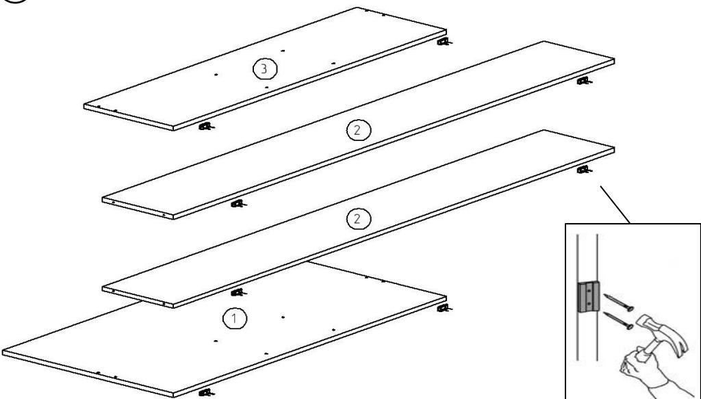
3. Установите на детали 1, 2, 3 подпятники с помощью гвоздей 2,0х25 мм.
