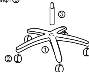
6. Сиденье установите отверстием в механизм ④ на газлифт ③
