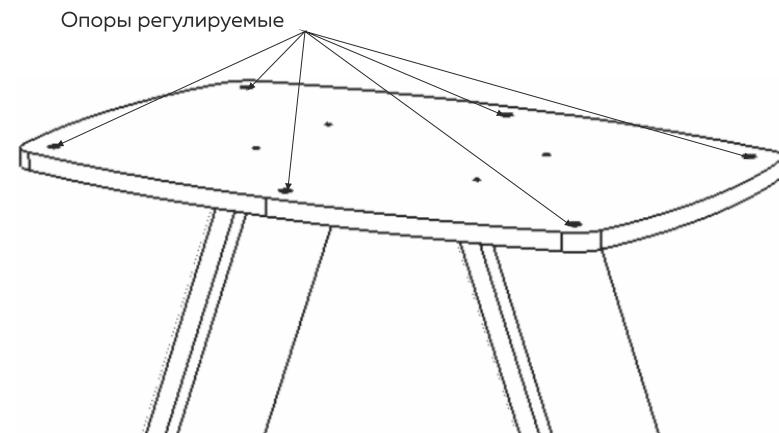
**6** Аккуратно перевернуть стол на основание. Регулировать шаткость стола подкручиванием опор.
