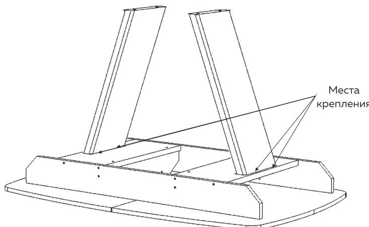
**4** Прикрепить основание с помощью Болта M8x50 и Шайбы M8
