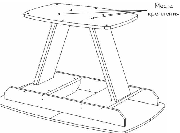
**5** Прикрутить регулируемые опоры в назначенные отверстия основания.
