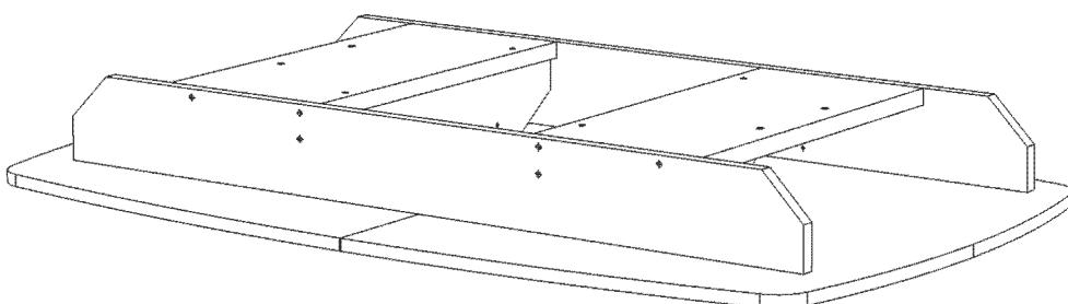
**3** Колонны прикрутить к столешнице с помощью болта M8x50 и Шайбы M8
