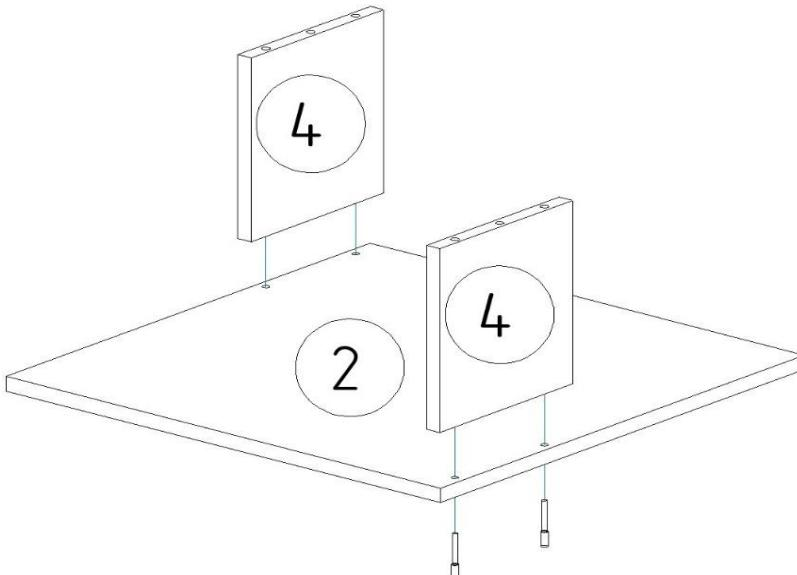
3. Соедините детали 2, 4 с помощью винтов евро 7x50 мм.
