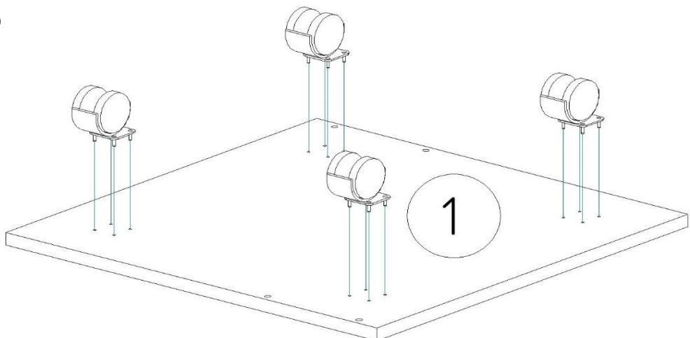
1. Установите на деталь 1 опоры с помощью саморезов 4x16 мм.
