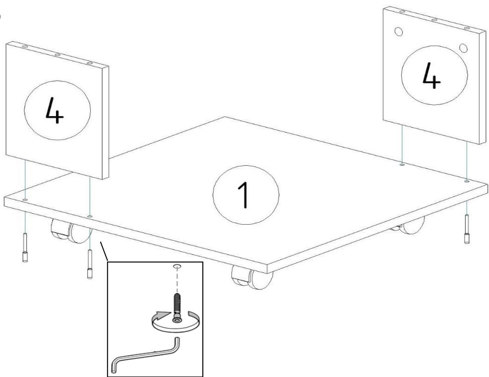
2. Соедините детали 1, 4 с помощью винтов евро 7x50 мм.
